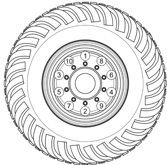
ABBILDUNG 5.4 Reihenfolge für das Lösen und Anziehen der Muttern.
